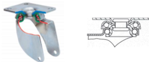
Fabricada con chapa de acero embutida hasta 2 mm de espesor. Soporte con una hilera de bolas. Acabado cincado. Ruedas de goma de 50 y 60 de diámetro con protectores incluidos de serie. Fabricadas según normas europeas EN 12528..
