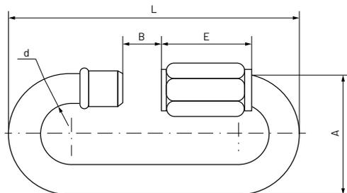
La malla rápida, es un eslabón muy eficaz a la hora de conseguir uniones rápidas, especialmente de cadenas. La forma hexagonal externa combinada con la rosca interior de cierre, garantizan un perfecto funcionamiento y una óptima seguridad de la aplicación.
