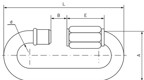
La malla rápida es un tipo de eslabón muy eficaz para conseguir uniones rápidas de cadenas. La forma hexagonal externa combinada con el roscado interno del dispositivo de cierre garantiza una perfecta funcionalidad y una óptima seguridad de aplicación.
