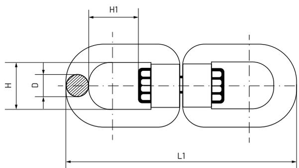
Las anillas giratorias inoxidable, están especialmente indicadas para aplicaciones donde la elevación de cargas, elementos a transportar o amarrar, precisen de movimientos direccionales opuestos entre ambos extremos, evitando las anillas giratorias que la cadena o cabo se retuercen.
