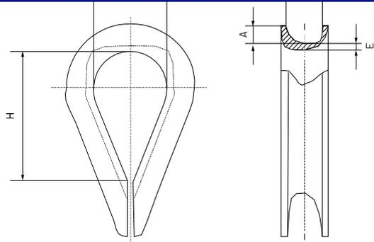
El guardacabo es un elemento imprescindible para garantizar la protección del cable en el momento de producirse cualquier tipo de rozadura o fricción.
