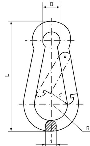
Gracias al diseño del gozne, el mosquetón de bombero inoxidable, es específicamente indicado para montajes rápidos donde no esté comprometida la posible apertura de dicho elemento y en usos temporales que precisen ser montados y desmontados con rapidez y continuidad.
