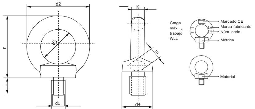
La anilla de elevación Macho, está especialmente indicada cuando la carga a elevar o amarrar, dispone de una superficie física perfectamente plana. La anilla de elevación Macho es unida a la parte a elevar o amarrar mediante el espárrago roscado de la propia anilla, garantizando así la perfecta unión de las dos partes y su posterior seguridad en la elevación o amarrado de la carga.
