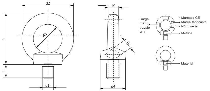
La anilla de elevación macho, está especialmente indicada cuando la carga a elevar o amarrar, dispone de una superficie física perfectamente plana. La anilla de elevación macho es unida a la parte a elevar o amarrar mediante el espárrago roscado de la propia anilla, garantizando así la perfecta unión entre las dos partes y su posterior seguridad en la elevación o amarrado de la carga.
