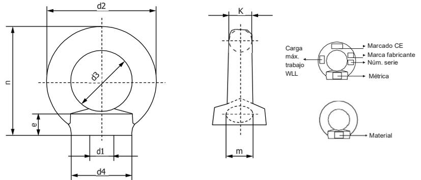
La anilla de elevación hembra, está especialmente indicada cuando la carga a elevar o amarrar, dispone de una superficie física perfectamente plana. La anilla de elevación hembra es unida a la parte a elevar o amarrar mediante un espárrago que es introducido dentro de la parte roscada de la propia anilla, garantizando así la propia unión entre las dos partes y su posterior seguridad en la elevación o amarrado de la carga.
