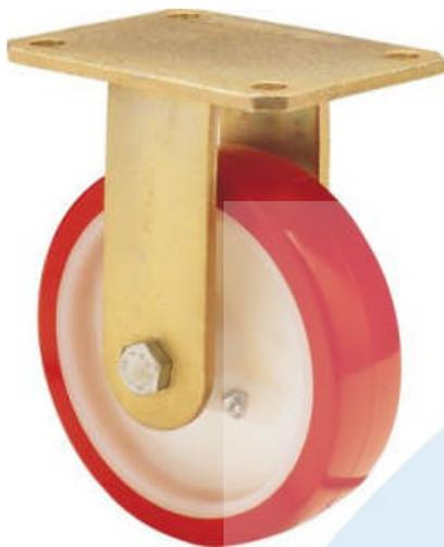
Ruedas con núcleo de nylon blanco y banda de poliuretano rojo dureza 90-95° shore A. Especialmente indicada para soportar altas cargas de hasta 600 Kg.
