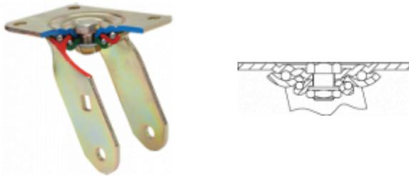
Fabricada con chapa de acero hasta 6m/m de espesor. Acabado cincado bicromatizado. Cabezal giratorio con una pista endurecida de doble hilera de bolas, para una mayor longevidad de la rueda. Fabricadas según normas europeas EN 12532.
