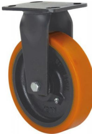
Ruedas con núcleo de acero y banda de poliuretano fundido con dureza de 95 ° shore A, especialmente indicada para soportar altas cargas hasta 1.250 Kg.
