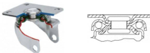
Soporte embutido de chapa de acero hasta 3 mm de espesor. Acabado cincado. Soporte con rodamiento de bolas. Fabricadas según normas europeas EN 12528.
