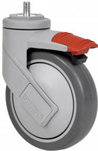
Rueda de goma termoplástica gris inyectada. Soporte fabricado en poliamida de alta calidad endurecida con fibra de vidrio. Cabezal giratorio superior construido en doble hilera de bolas endurecidas (fijación placa y agujero pasante) y cojinete de bolas de precisión insertado (fijación espiga roscada). Especialmente indicadas para soportar cargas hasta 100 Kg.
