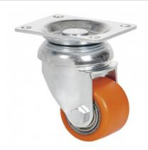
Ruedas con núcleo metálico y banda de poliuretano vulcanizado con una dureza 95° shore A. Especialmente indicada para soportar cargas hasta 100 Kg con mínima altura.
