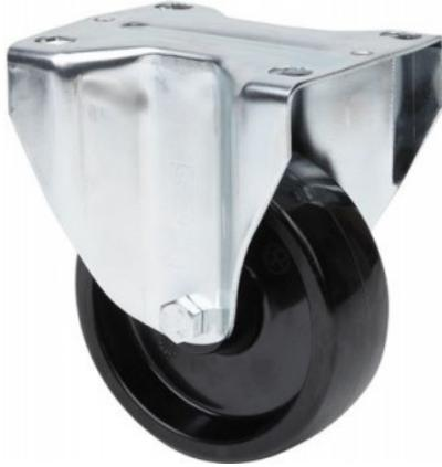
Ruedas de resina, especialmente indicada para soportar altas temperaturas de hasta 300° y cargas hasta 125 Kg.
