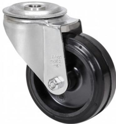
Ruedas de goma negra, especialmente indicada para soportar temperaturas de hasta +250°C en intervalos de 30 minutos. Soportan cargas hasta 100 Kg. Con todos sus componentes de acero inoxidable (AISI 304).
