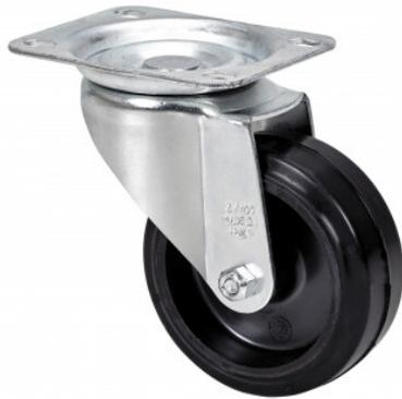
Ruedas de goma negra, especialmente indicada para soportar temperaturas de hasta +250°C en intervalos de 30 minutos. Soportan cargas hasta 100 Kg. Con todos sus componentes de acero inoxidable (AISI 304).
