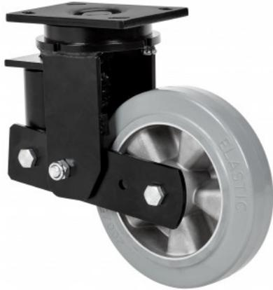
Ruedas de núcleo de aluminio con banda de goma gris elástica con una dureza 70° shore A. Especialmente indicada para soportar altas cargas hasta 450 Kg. Con soporte de suspensión elástica mediante incorporación de muelle muy resistente para absorber golpes, choques y desniveles. Recorrido de suspensión hasta 25mm., ideal en suelos irregulares donde su amortiguación actúa.
