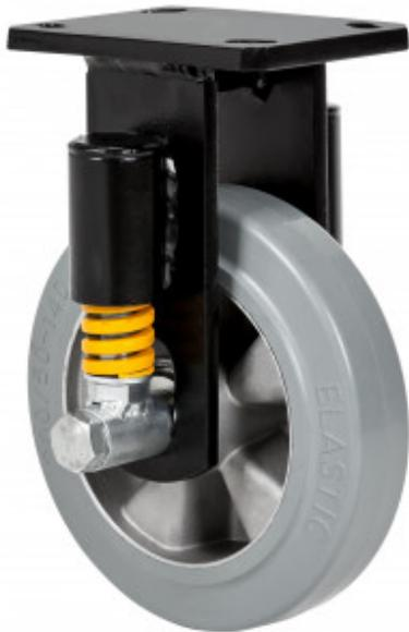
Ruedas de núcleo de aluminio con banda de goma gris elástica con una dureza 70° shore A. Especialmente indicada para soportar altas cargas hasta 450 Kg. Con soporte de suspensión elástica mediante incorporación de muelle muy resistente, ideal en suelos irregulares donde su amortiguación actúa.
