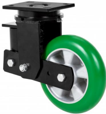
Ruedas con núcleo de aluminio y banda de poliuretano verde fundido en forma balona con dureza 80° Shore A. Especialmente indicada para soportar cargas hasta 650 Kg. Con soporte de suspensión elástica mediante incorporación de muelle muy resistente para absorber golpes, choques y desniveles. Recorrido de suspensión hasta 25mm., ideal en suelos irregulares donde su amortiguación actúa.
