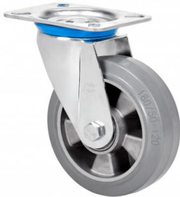
Ruedas de núcleo de aluminio con banda de goma elástica gris con una dureza 70° shore A. Especialmente indicada para soportar cargas hasta 450 Kg.
