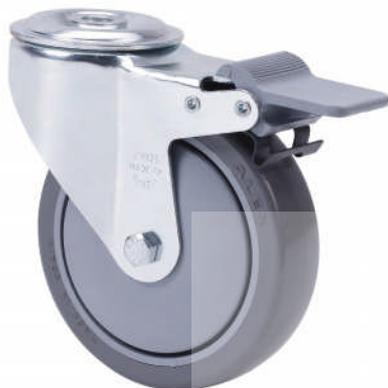
Ruedas de núcleo de polipropileno y banda de poliuretano gris inyectado. Especialmente indicada para soportar cargas hasta 200 Kg. Se aplica en útiles de transporte logístico, taller, carros de transporte alimentación, cocina, cantina, factorías alimentación, supermercados. Aplicadas en proyectos de ingeniería mecánica por delineantes y proyectistas.
