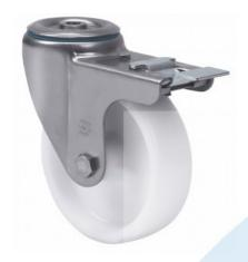
Ruedas de poliamix blanco con todos sus componentes de acero inoxidable (AISI 304). Especialmente indicada para soportar cargas hasta 400 Kg.
