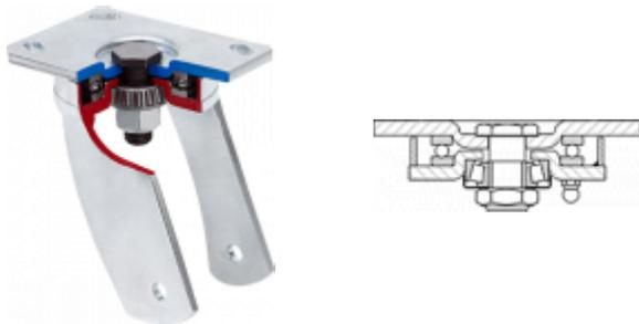
Fabricada con chapa de acero hasta 8m/m de espesor. Doble cabezal giratorio, el superior de bolas grandes de acero y el inferior de precisión que facilita los esfuerzos de giro, radiales y axiales. Modelo construido especialmente para: carretillas grandes con empuje mecánico, manutención de factorías, industrias metalúrgicas. Acabado cincado blanco. Fabricadas según normas europeas EN 12532.
