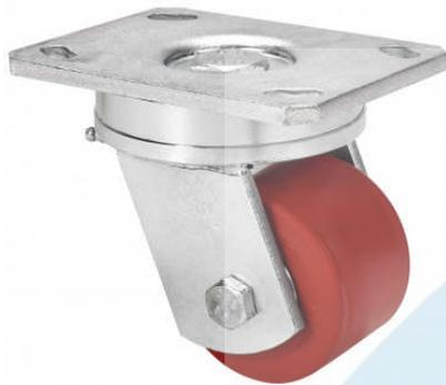
Ruedas con núcleo nylon y banda de poliuretano inyectado, especialmente indicada para soportar altas cargas hasta 450 Kg.
