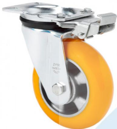
Ruedas con núcleo de aluminio y banda de poliuretano fundido con dureza de 95° shore A, con banda de rodadura en forma balona, especialmente indicada para soportar altas cargas hasta 700 Kg.
