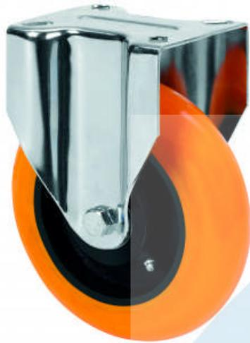
Ruedas con núcleo de acero y banda de poliuretano fundido con dureza de 95° shore A, con banda de rodadura en forma balona, especialmente indicada para soportar altas cargas hasta 700 Kg.
