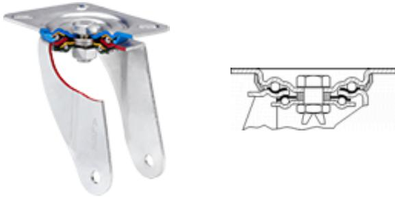
Fabricada con chapa de acero embutido hasta 4mm de espesor. Doble rodamiento a bolas reforzado con pistas de rodadura endurecidas. Protector anti-polvo en el cojinete del soporte con engrasador Fabricadas según normas europeas EN 12532/12533.
