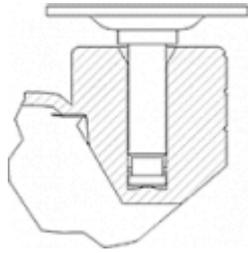
Fabricada en poliamix reforzado Aros: núcleo de poliamix y banda de goma o material especial conductor Freno ergonómico redondeado con retorno integrado Soporte con espiga lisa o roscada, con y sin freno Color personalizado opcional.
