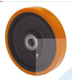
Aros de poliuretano fundido. Núcleo: Acero o aluminio. Banda: Poliuretano rojo o naranja. Cojinetes: Liso, bolas y timken. Rango de temperatura: -20°a +60°.
