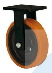
Ruedas con núcleo de acero y banda de poliuretano fundido con dureza de 95° shore A, especialmente indicada para soportar altas cargas hasta 1.900 Kg.
