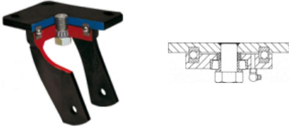
Fabricada con acero soldado hasta 8 m/m de espesor. Acabado pintado negro. Combinación de cojinetes de bolas y conicos en el soporte: el superior para esfuerzos axiales, y el inferior para esfuerzos radiales. Engrasadores en el cabezal del soporte y en la rueda. Fabricadas según normas europeas EN 12532/12533.
