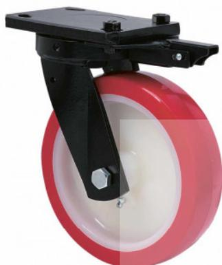
Ruedas con núcleo de nylon blanco y banda de poliuretano rojo dureza 90-95° shore A. Tracción mecánica. Especialmente indicada para soportar altas cargas de hasta 600 Kg.
