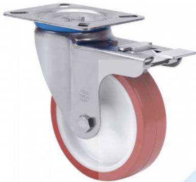
Ruedas de poliuretano inyectado con todos sus componentes de acero inoxidable (AISI 304). Especialmente indicada para soportar cargas hasta 300 Kg.
