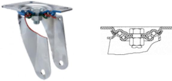
Fabricada con chapa de acero embutido hasta 5m/m de espesor. Acabado cincado brillante de alta resistencia al óxido. Doble rodamiento a bolas reforzado con platillos intermedios y pistas de rodadura endurecidas. Protector anti-polvo en el cojinete del soporte. Modelo diseñado especialmente para: Carretilas industriales manuntención de factorías, contenedores de trabajo duro, industrias metalúrgicas, químicas, servicios públicos, etc. Fabricadas según normas europeas en 12532.
