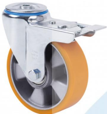
Ruedas con núcleo de aluminio y banda de poliuretano fundido de dureza 95° shoreA. Especialmente indicada para soportar cargas hasta 400 Kg.
