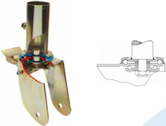
Fabricada con chapa de acero embutida hasta 4m/m de espesor. Acabado cincado bicromatizado. Freno de doble acción regulable. Gran capacidad de carga. Tubo de 51mm de interior x 120 mm de alto en espiga cazoleta. Tubo de 40mm de Exterior x 135mm de alto en espiga sólida. Fabricadas según normas europeas EN 12532.
