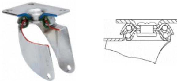
Fabricada con chapa de acero hasta 2 m/m de espesor. Soporte con doble rodamiento a bolas. Acabado cincado brillante. Fabricadas según normas europeas EN 12528/12530.
