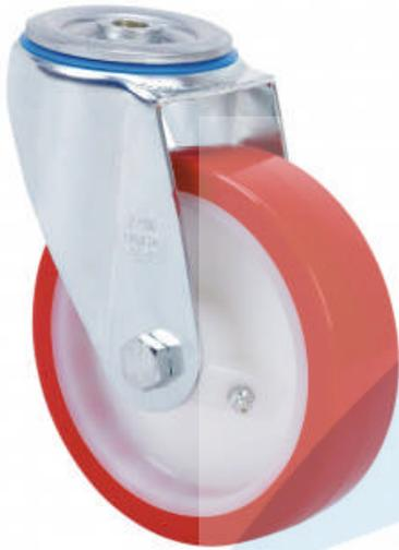
Ruedas con núcleo de nylon blanco y banda de poliuretano rojo inyectado de dureza 90-95° shoreA. Especialmente indicada para soportar cargas hasta 400 Kg.
