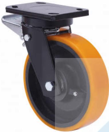
Ruedas con núcleo de acero y banda de poliuretano fundido con dureza de 95° shore A, especialmente indicada para soportar altas cargas hasta 1.900 Kg.
