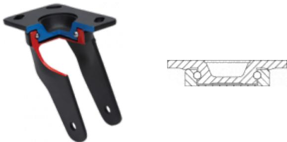
Fabricada con acero forjado hasta 8 m/m de espesor. Acabado pintado negro. Cabezal giratorio con bolas de acero de gran dureza diseñado para soportar esfuerzos radiales y laterales. Cabezal totalmente hermético con engrasador. Fabricadas según normas europeas EN 12532/12533.
