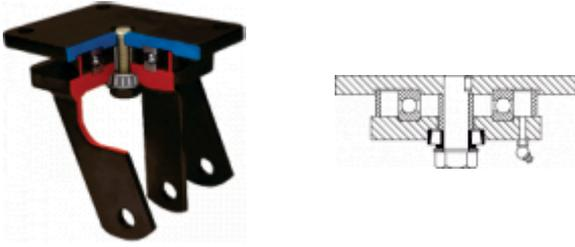
Fabricada con chapa de acero soldado hasta 8 m/m de espesor. Acabado pintado negro. Combinación de cojinetes de bolas y conicos en el soporte: el superior para esfuerzos axiales, y el inferior para esfuerzos radiales. Cabezal giratorio hermético, con engrasadores en el cabezal del soporte y en la rueda. Fabricadas según normas europeas EN 12532/12533.
