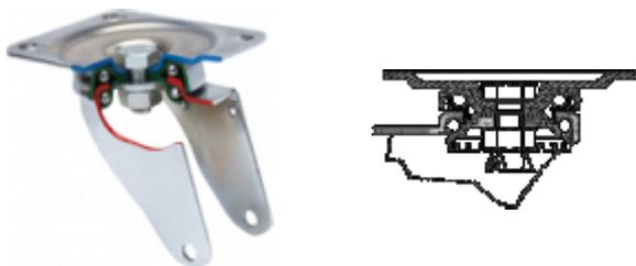
Fabricada con chapa de acero hasta 2,5 mm de espesor. Soporte con doble rodamiento a bolas con pistas complementarias endurecidas. Acabado cincado cromado. Gran variedad de fijaciones, frenos, ruedas. Fabricadas según normas europeas EN 12530.
