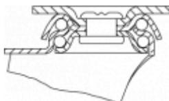
Fabricada con chapa de acero hasta 2 m/m de espesor. Soporte con doble rodamiento a bolas. Acabado cincado brillante. Fabricadas según normas europeas EN 12528/12530.
