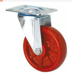
Ruedas de resina extrafuerte, especialmente indicada para soportar altas temperaturas y cargas hasta 600 Kg. Con todos sus componentes de acero inoxidable (AISI 304).
