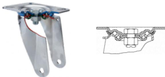
Chapa de acero hasta 4mm de espesor. Acabado cincado brillante. Soporte embutido con doble hilera de bolas. Modelo de uso universal para cargas medias. Fabricadas según normas europeas EN 12530/12532.
