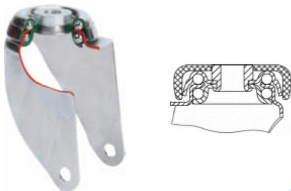
Fabricada con chapa de acero hasta 2 m/m de espesor. Soporte con doble rodamiento a bolas. Acabado cincado. Especialmente diseñada para: Carros de Supermercado. Fabricadas según normas europeas EN 12530.
