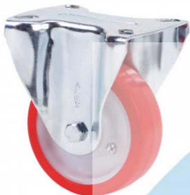
Ruedas con núcleo de nylon blanco y banda de poliuretano rojo dureza 90-95° shore A. Especialmente indicada para soportar altas cargas de hasta 600 Kg.
