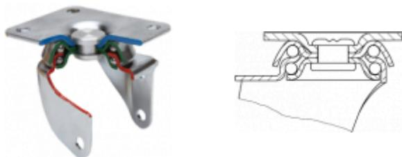
Fabricada con chapa de acero hasta 2 m/m de espesor. Soporte con doble rodamiento a bolas. Acabado cincado. Fabricadas según normas europeas EN 12528.
